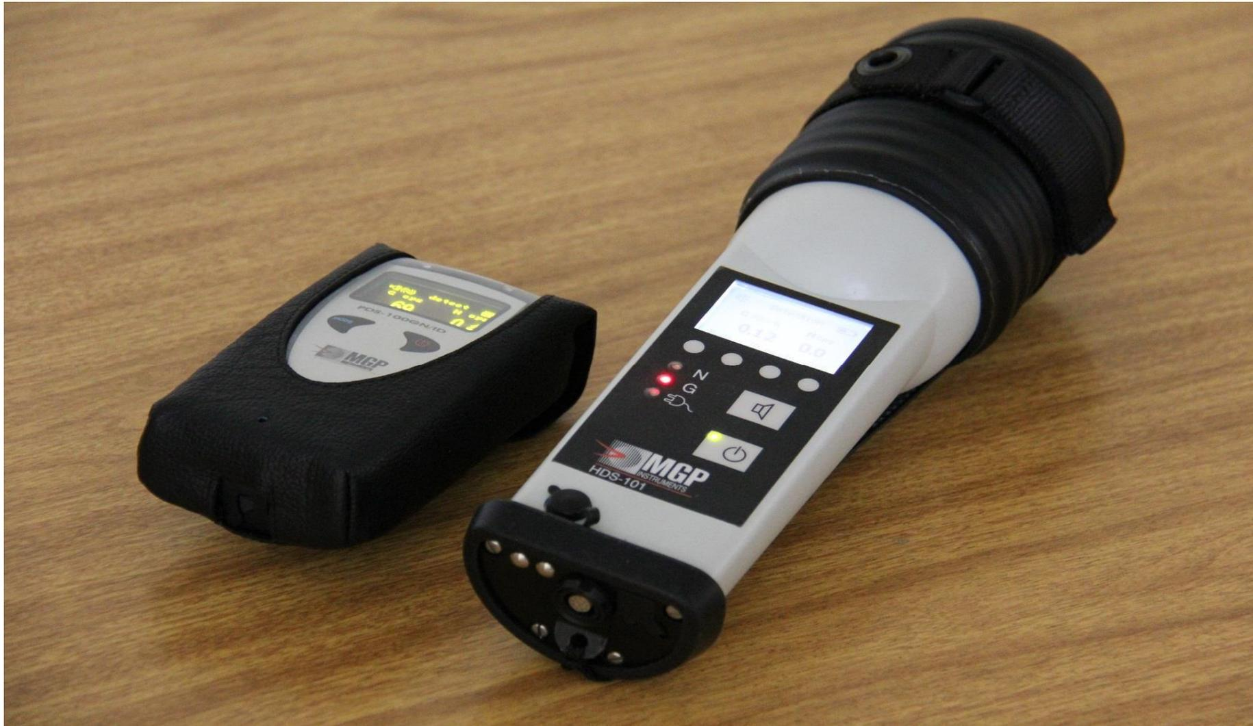
**Equipamentos Radiológicos Usados na Copa do Mundo 2014 para quantificação da Dose e taxa de Dose e Principalmente a Identificação do Radionuclídeo. Pequenos portes**
