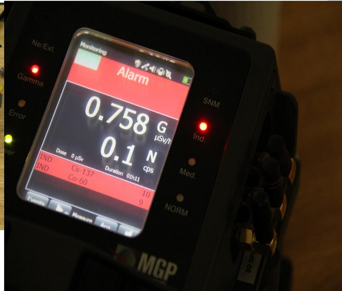
**Equipamentos Radiológicos Usados na Copa do Mundo 2014 para Varredura (uso de extensores) e Controle de Acesso. Quantificação da Dose e taxa de Dose e Principalmente a Identificação do Radionuclídeo. Médio porte.**
