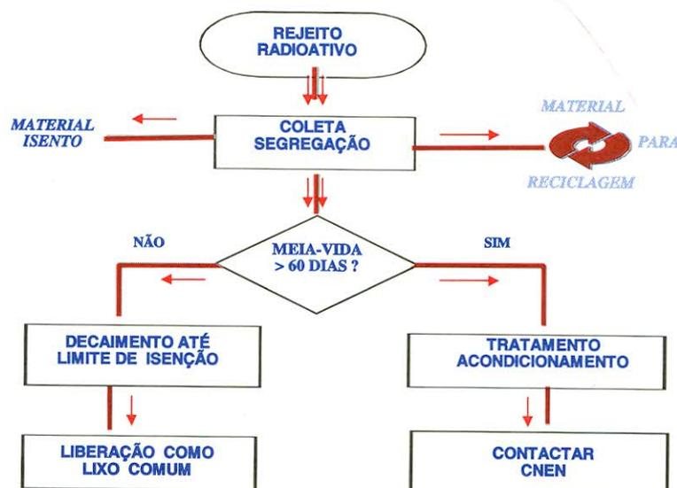
Figura 2 - Fluxograma básico de gerência de rejeitos radioativos. Adaptado de "Gerência de Rejeitos Oriundos da Medicina Nuclear e Pesquisa". Nota Técnica CODIN/SLC/CNEN 1996.
